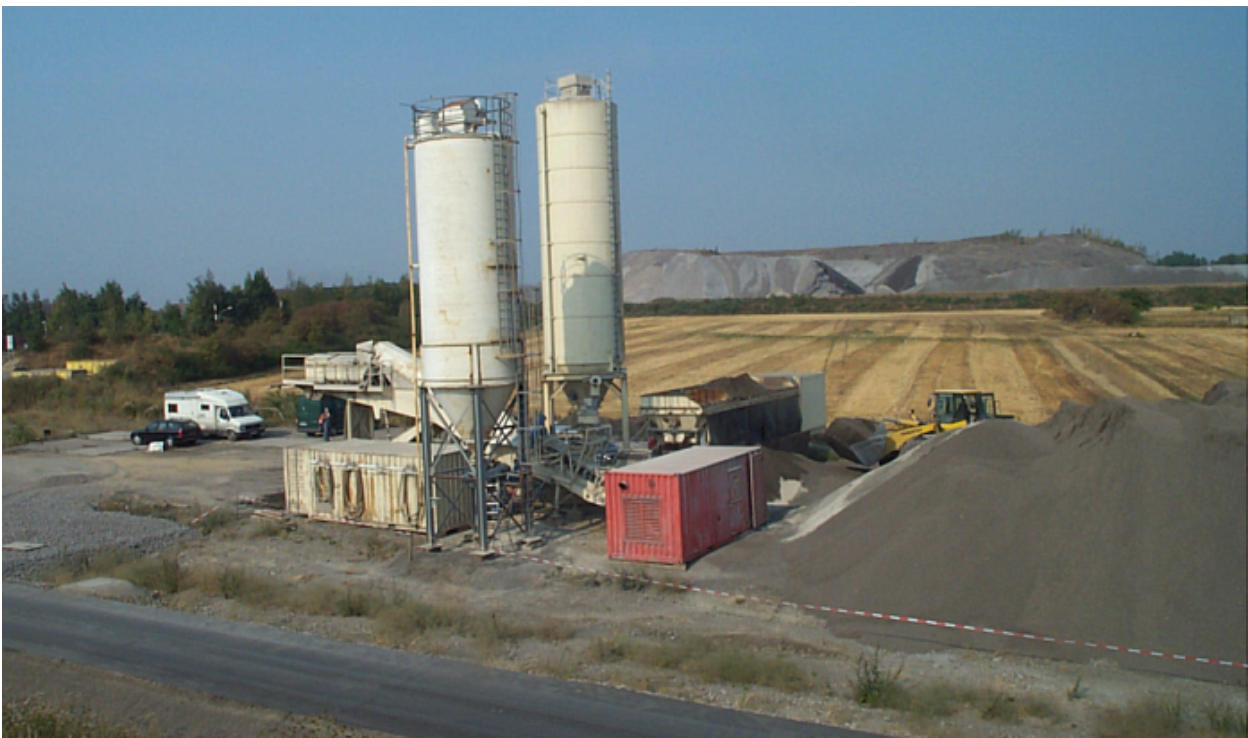
Abbildung 1 Feldfabrik für die Produktion von Tonschlacken
